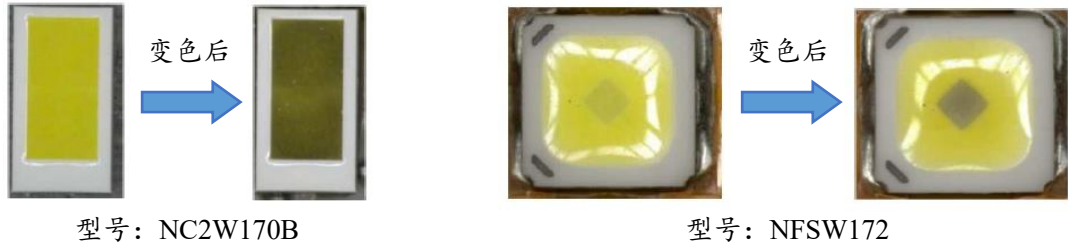
图 6. VOC 导致的 LED 变色例
