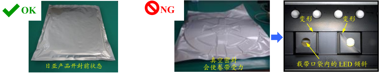
图 2. 真空保管和编带载带的变形
